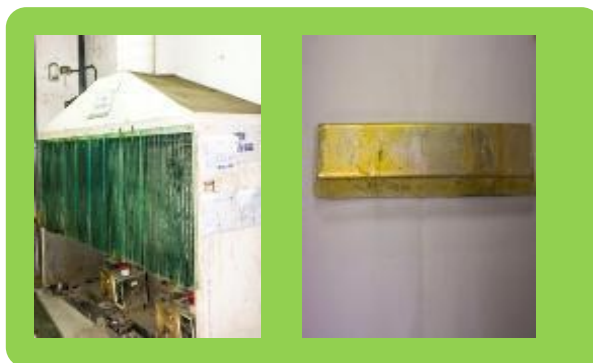
設立錫渣回收機再製錫錠
